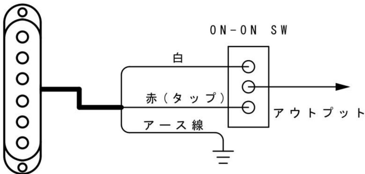
\*VGS-100 のタップを使用する場合は、ON-ON の SW を使用し白と赤(タップ線)を両端子に繋ぎセンター端子をアウトプットにして下さい。
